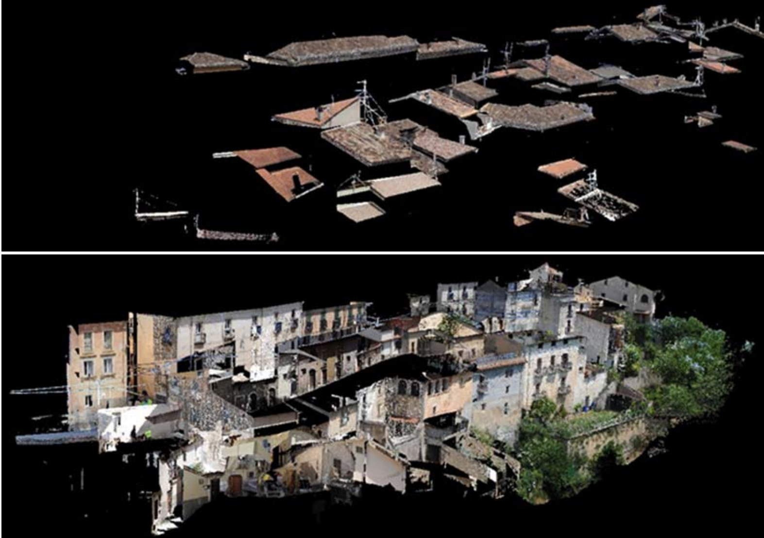
Diagramma che illustra il processo di fusione del LiDAR con Laser Scanner Terrestre
