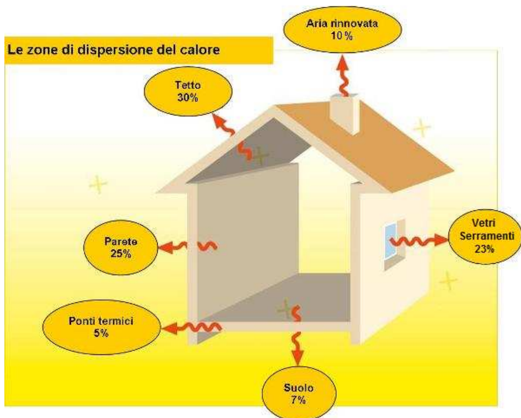
Figura 10: schema delle dispersioni termiche dell'involucro edilizio
