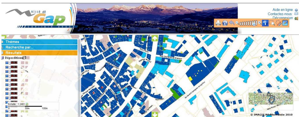
Figura 2: sistema informativo territoriale della ville di Gap, con mappa delle dispersioni termiche delle coperture
