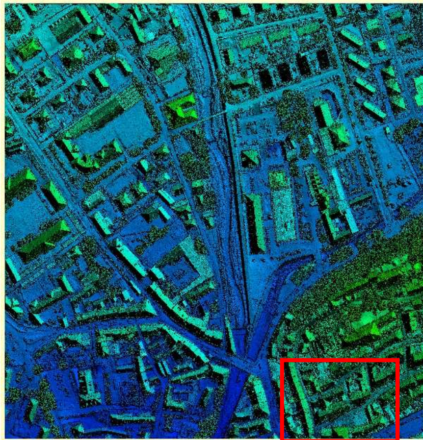
Figura 50: rappresentazione tramite generazione di superfici triangolari dei punti desunti da volo LIDAR, in rosso l'area campione oggetto di studio
