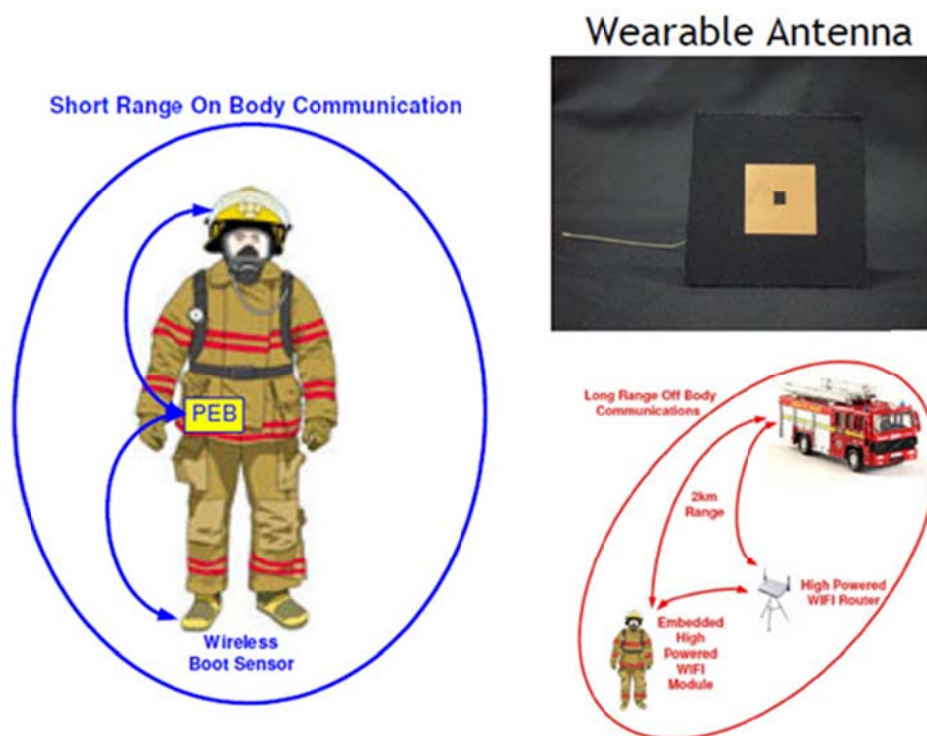
Figura 0-17 - Sistema di comunicazione, Professional Electronic Box (PEB).
