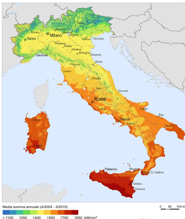
Figura 39: Radiazione solare globale sul piano orizzontale.
