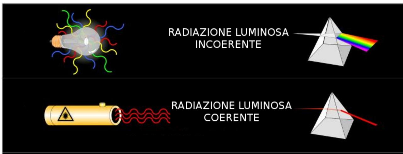
Figura 68: Radiazione luminosa incoerente e coerente.
