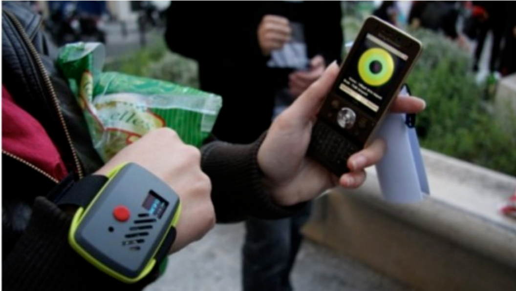
Figura 6 - Sensore “montre verte” per il rilievo dell’inquinamento acustico
