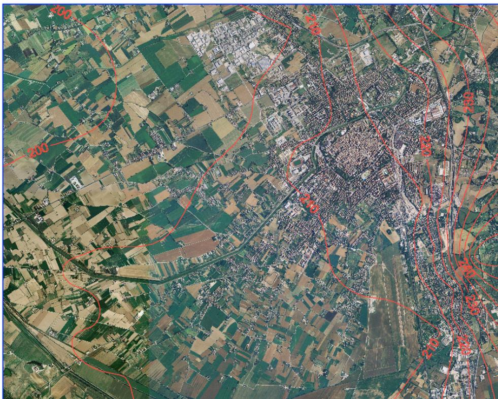
*Figura 72. Carta delle Isopieze della falda idrica freatica contenuta nei depositi alluvionali nell'area di Foligno su foto aeree del 2005. Fonte dati: Comune di Foligno.*
