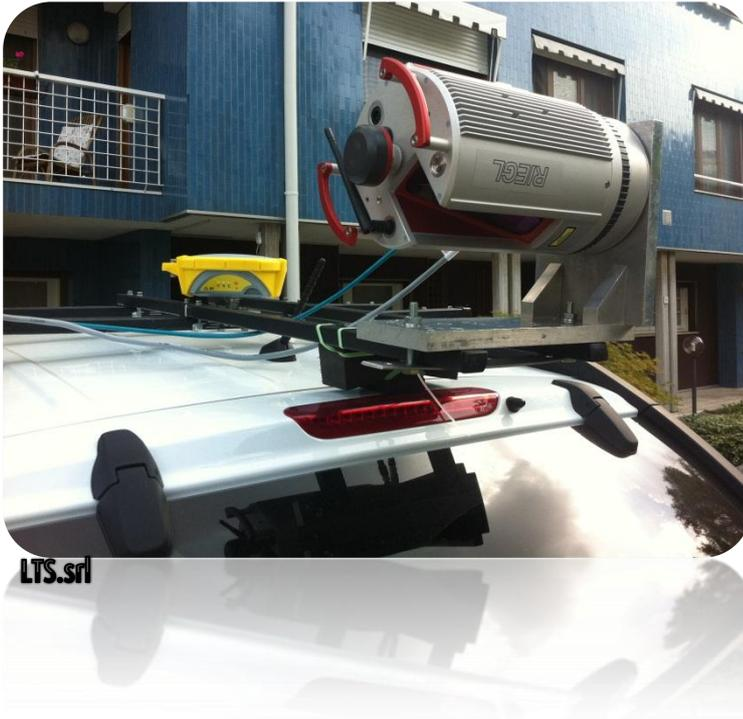
*Attrezzatura maobile mapping system laser LTS.srl*
