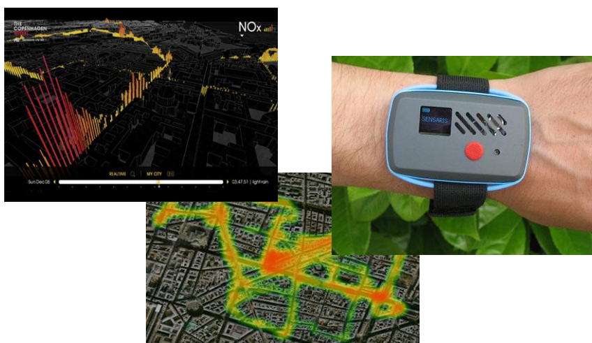
Mappatura della qualità dell'aria con sensori mobili e wearable
