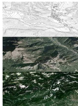
velivolo, che permette di determinare la distanza di un oggetto o di una superficie utilizzando un impulso laser. Il lidar usa lunghezze d'onda ultraviolette, nel visibile o nel vicino infrarosso; questo rende possibile localizzare e ricavare immagini e informazioni su oggetti molto piccoli, di dimensioni pari alla lunghezza d'onda usata. Attraverso i lidar aerotrasportati è possibile costruire modelli digitali del terreno e della superficie (DTM DSM) ad altissima precisione.
