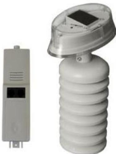
FIGURA 41 - A SINISTRA SENSORE DI TEMPERATURA DHT22 , A DESTRA NELL'ALLOGGIAMENTO CON SCHERMO SOLARE E PANNELLO SOLARE PER ALIMENTAZIONE DEL GRUPPO SENSORI. FOTO DELL'AUTORE.
