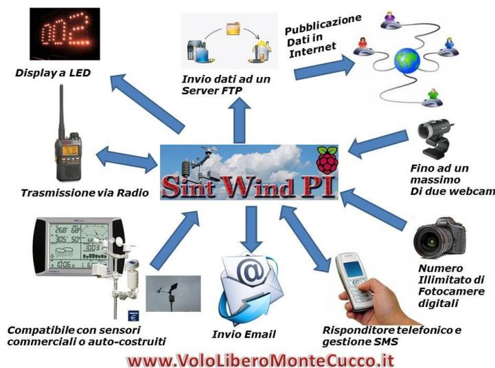
FIGURA 117 – SCHEMA DELLE FUNZIONALITÀ GESTITE DA SINT WIND PI.
