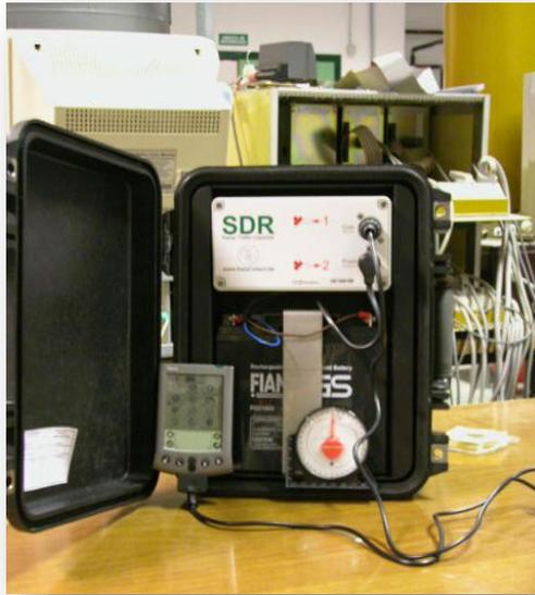
**Figura 51: Rilevatore traffico radar EasyData**
