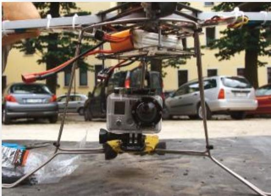
**Figura 38 :Camera con culla stabilizzata**
