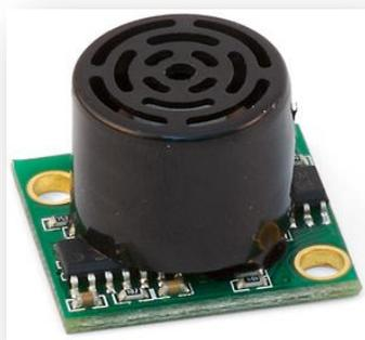
Figura 55: Sonar ad ultrasuoni-
