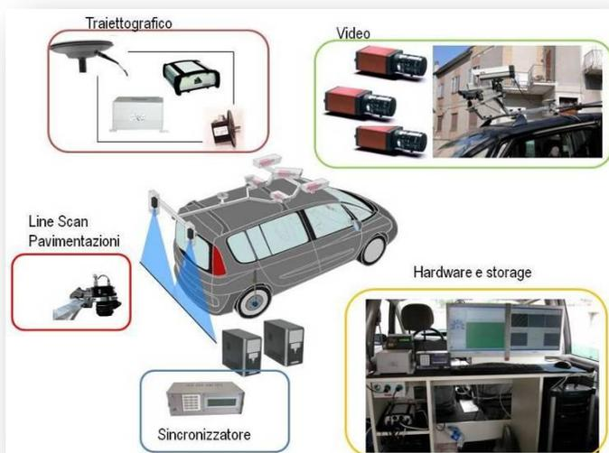
**Figura 80: Architettura hardware del sistema**
