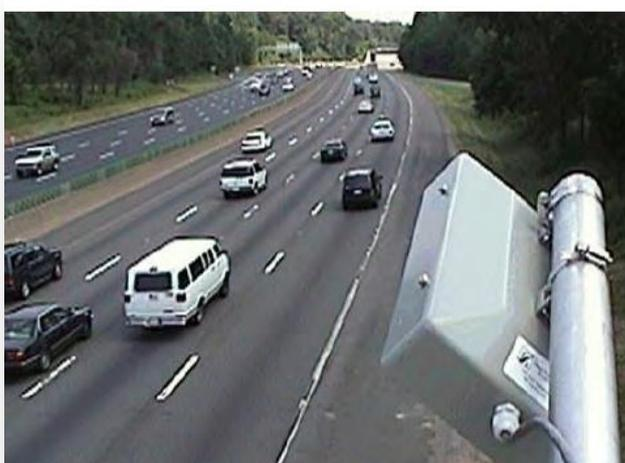
**Figura 56: Sensore acustico passivo**
