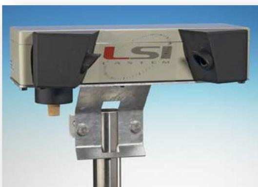
Figura 62: sensore visibilità <http://www.lsi-lastem.it/>
