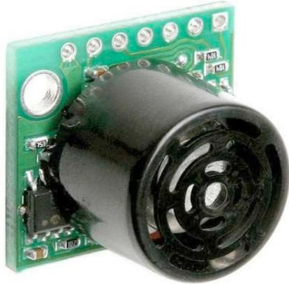
*Figura 14 - Sensore ad ultrasuoni*
