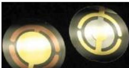
*Figura 18 - Cristalli di Quarzo per microbilance*
