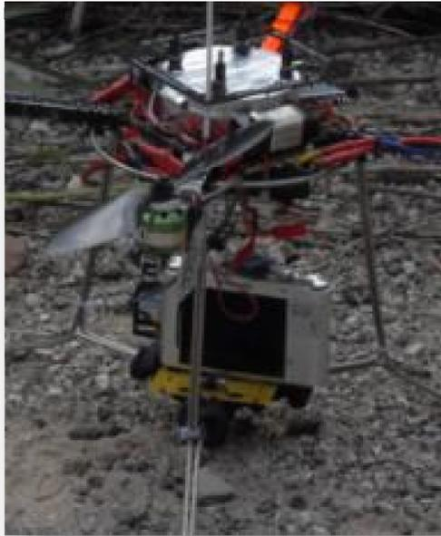
*Figura 85 - Culla artigianale per il montaggio di fotocamera*
