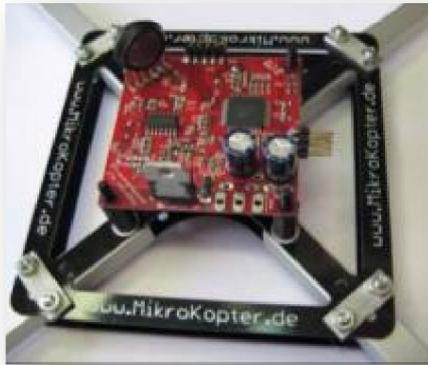
Figura 29 - Il "Cuore del quadritore", la flight control
