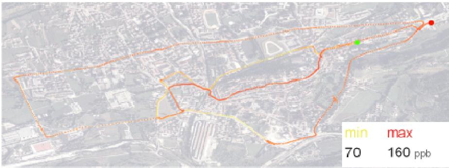
Informazioni di questo tipo hanno un elevato valore qualitativo che permette di visualizzare su una piattaforma geografica, in tempo reale, la distribuzione della concentrazione di un determinato gas o la misura di un parametro fisico quale temperatura o umidità.
