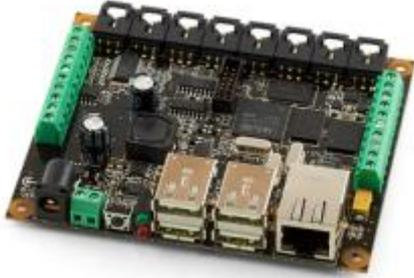
La soluzione SBC Phidgets rappresenta una soluzione commerciale a basso costo per la realizzazione di centraline multi sensore.
