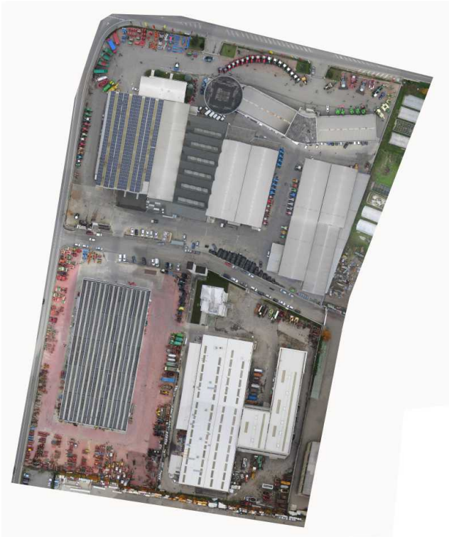
Rilievo SwingletCAM di circa 10 ha di area industriale con risoluzione di 4 cm/pixel – ortomosaico digitale
