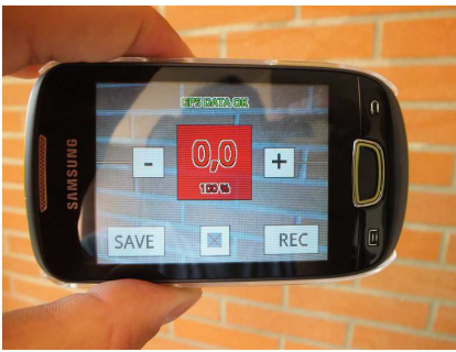
L'app VigDroid – target non vegetale (sx, valore indice: 0.0) e target vegetale (dx, valore indice: 8.3)
