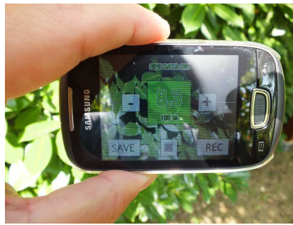
L'app VigDroid – target non vegetale (sx, valore indice: 0.0) e target vegetale (dx, valore indice: 8.3)
