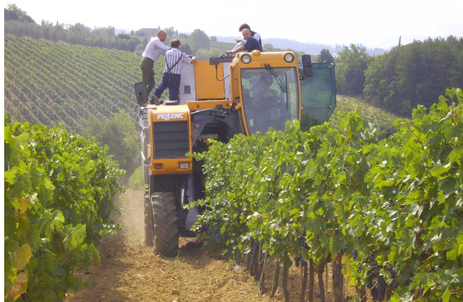
La vendemmiatrice a rateo variabile e la mappa di vigore utilizzata (vigneto Tramitoni)
