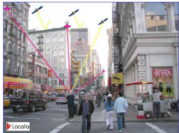
La tecnologia di posizionamento locale (LPS) di Locata Corp. PTY Limited, già integrata in alcuni prodotti Leica
