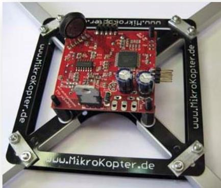
*Figura 23 - "cuore del quadritore", la flight control*
