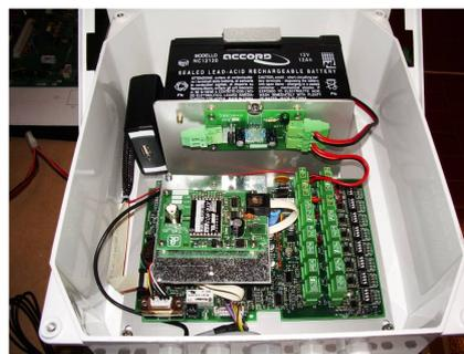
Figura 5.17 - Data logger dell'Unità Master
