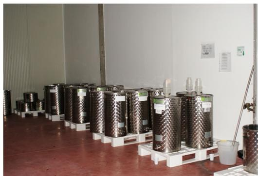
Figura 5.1 - Serbatoi per la vinificazione da 10 hl    Figura 5.2- Micro vinificazioni - 100 l
