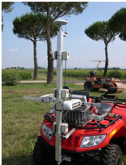
Figura 5.13 - Quad attrezzato con sensori di *proximal sensing*.
