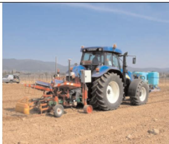
Figura 4.14 - Trapiantatrice equipaggiata con sistema di guida satellitare.
