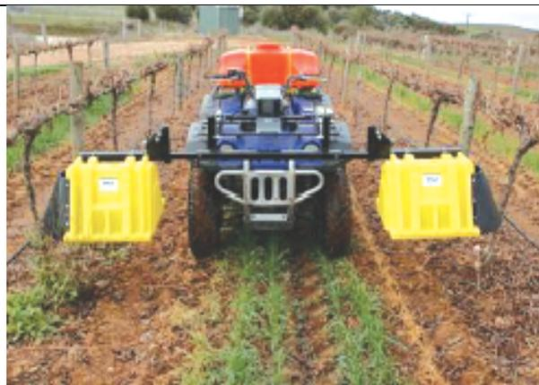
Figura 4.21 - Applicazione del sistema Weedseeker in vigneto su Quad 4x4. (fonte: Vieri, 2010).
