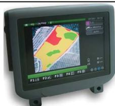
Figura 4.23 - Monitor per la visualizzazione delle mappe di prescrizione.
