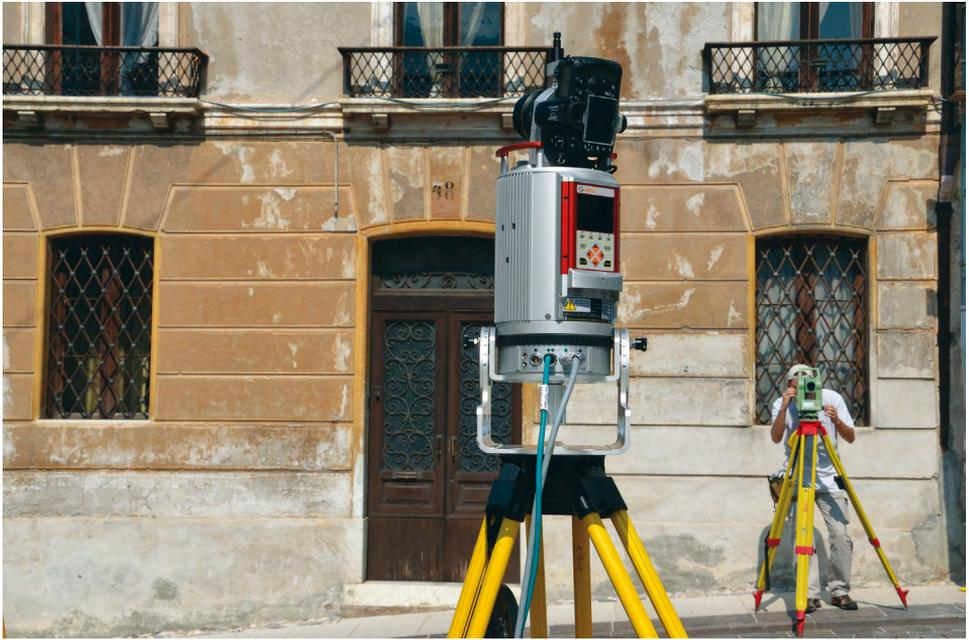
Fig. 6. La strumentazione laserscanner durante le fasi di rilievo a Feltre. Nell'immagine si può notare il sensore laser e la fotocamera reflex montato sopra di esso per registrare i colori reali degli elementi rilevati.
