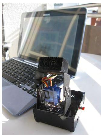
Fig. 1. Termocamera economica sviluppata e venduta da Max Ritter, <http://www.cheap-thermocam.net>.
