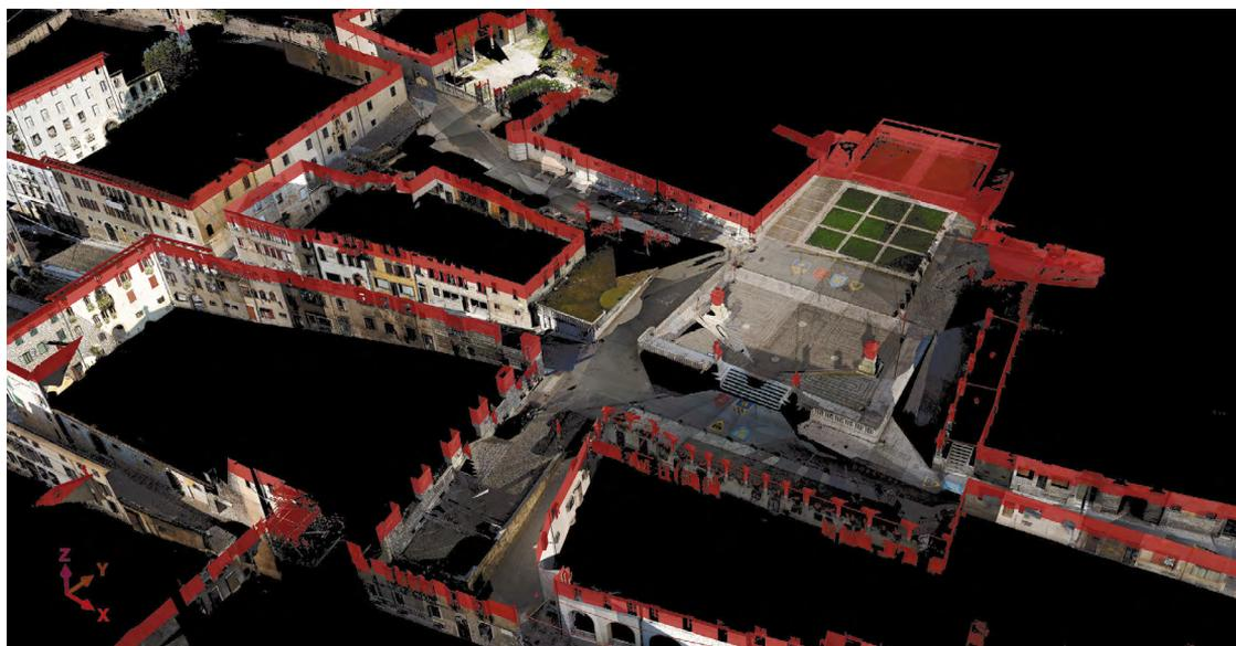
Fig. 15. Sezione di una parte del centro storico di Feltre ottenuta dal modello digitale complessivo.
