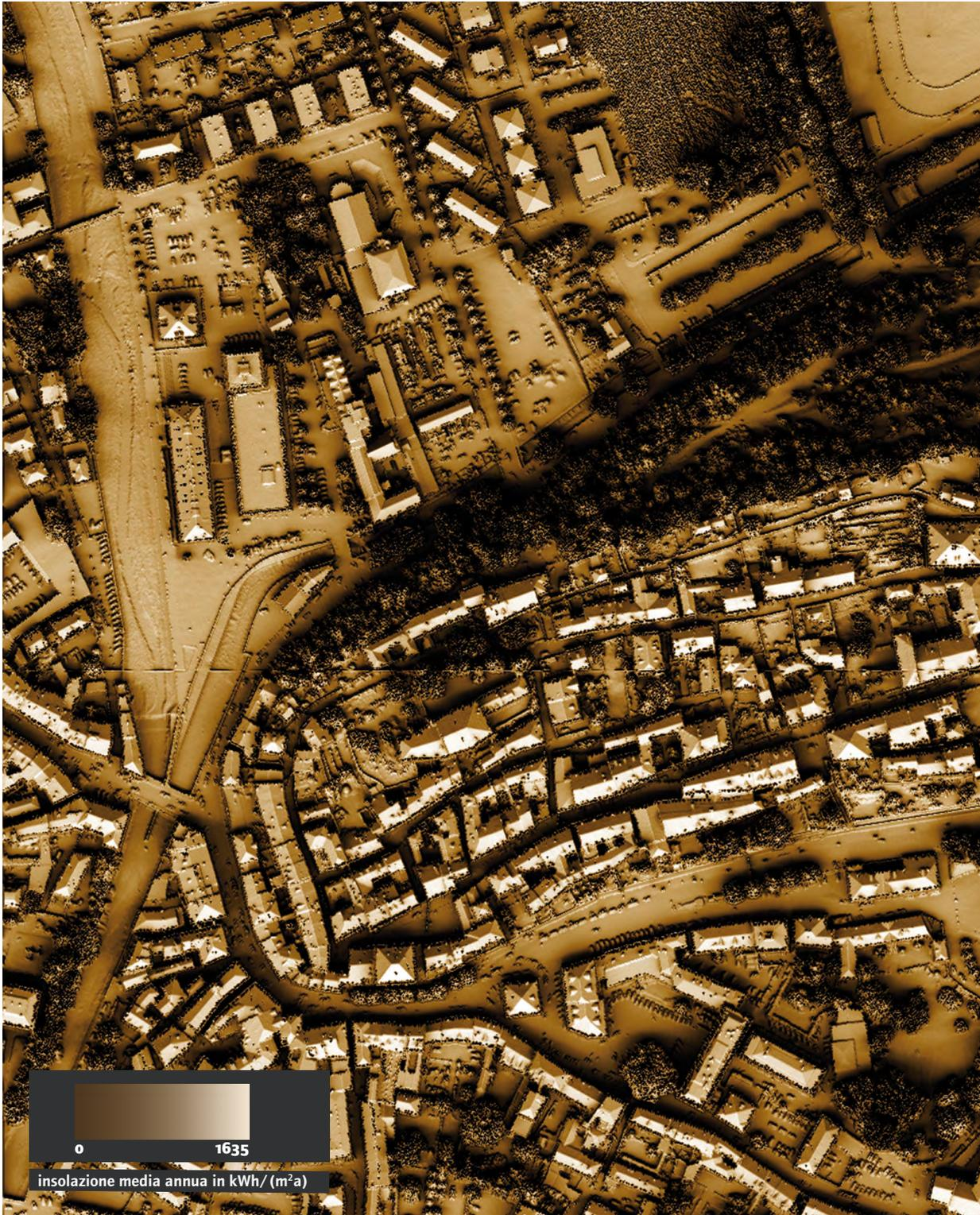
Fig. 20. Il risultato dell'analisi dell'irraggiamento solare medio annuo sulla città di Feltre. Il dato è stato ottenuto dalla fusione tra l'irraggiamento diretto e l'irraggiamento diffuso.
