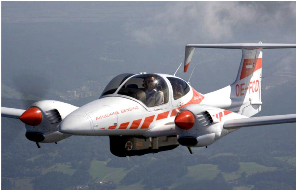
Fig. 4. Aeromobile equipaggiato con sistemi laser, *IMU-GPS* e dispositivo fotografico utilizzato per il rilievo di Feltre.
