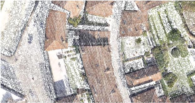
Fig. 11. Nuvola di punti da rilievo LIDAR colorata con le informazioni dell'ortofoto
