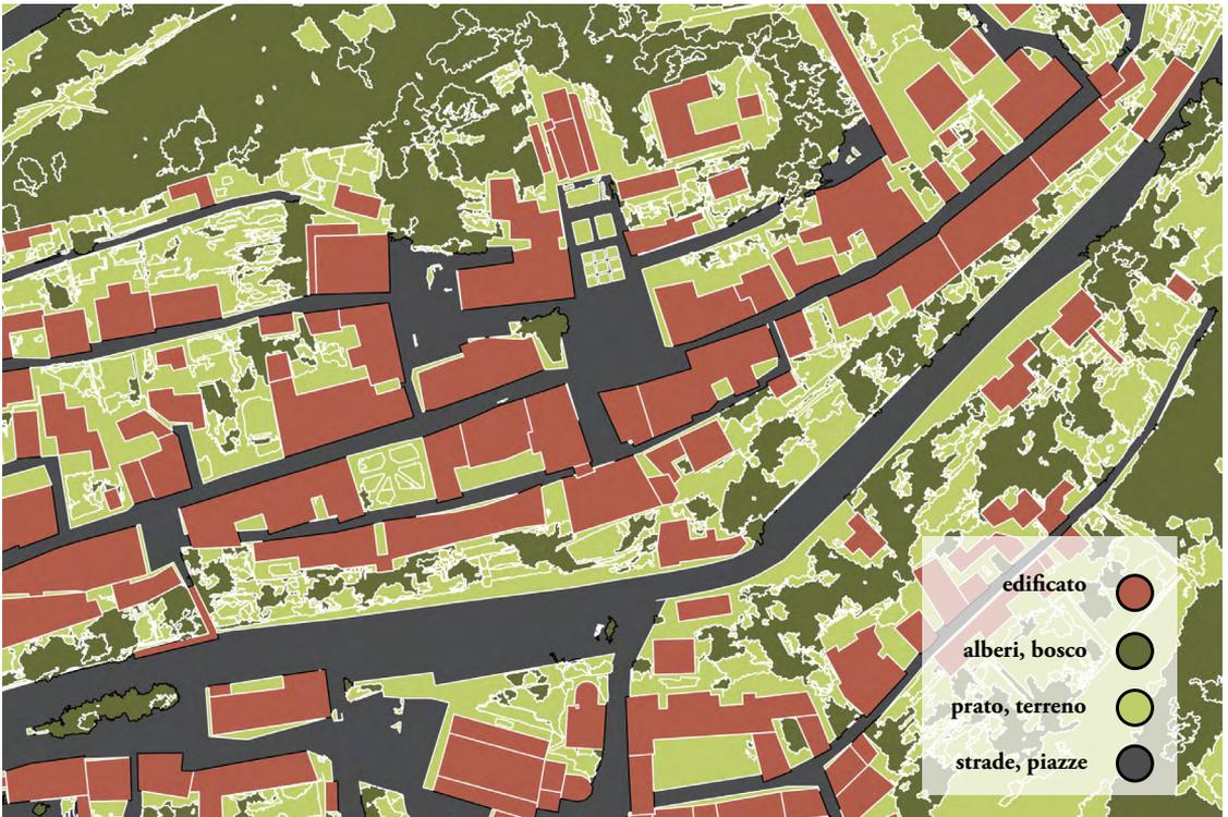
Fig. 21. Risultato della classificazione tematica degli *elementi urbani* ottenuta dal processamento integrato dell'ortofoto (immagine sopra) e dell'informazione 3D del dato LiDAR.
