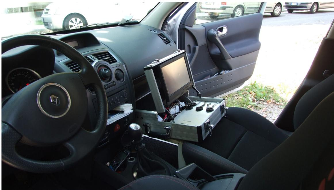
Alloggiamento di ICARO all'interno di una vettura
