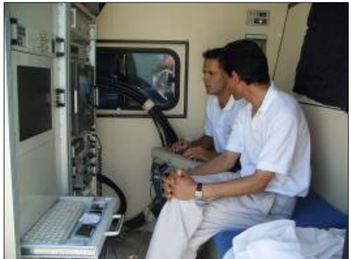
Il furgone utilizzato durante la fase di test con all'interno la strumentazione per il monitoraggio del volo in tempo reale ed il personale addetto al controllo della telecamera con joystick e zoom
