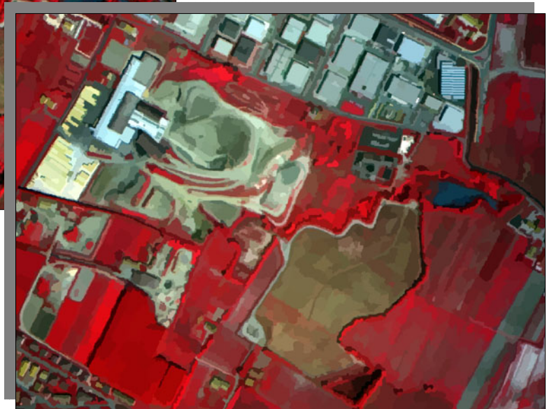
Il processo di segmentazione dinamica dell'immagine infrarosso (in alto l'immagine originale, a destra l'immagine classificata "ad oggetti", si tratta quindi di clusterizzazione dei pixel)
