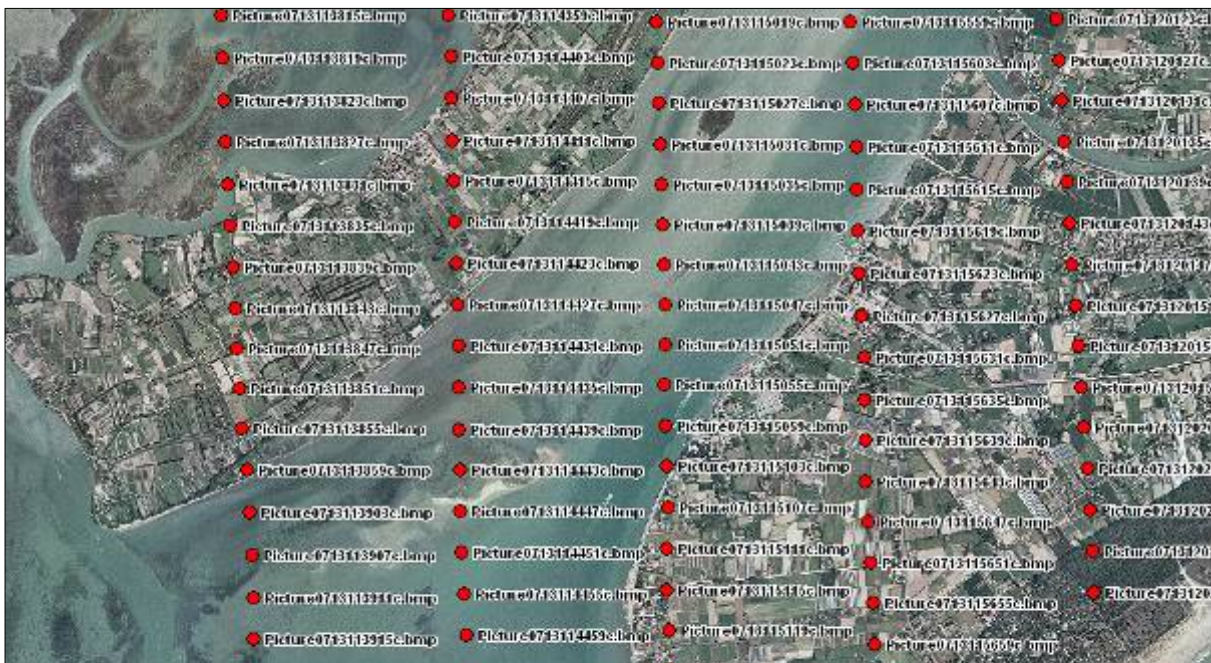
Il log restituito dal GPS a bordo e la mappatura delle strisciate relative ai singoli punti di scatto riferita ad una delle aree test
