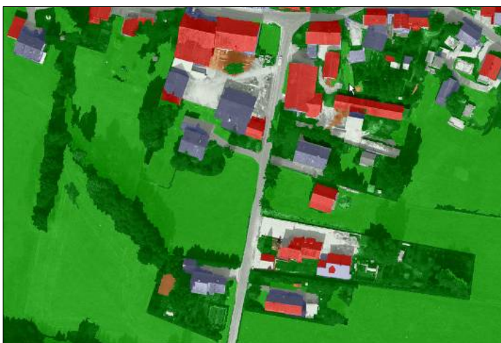
Un esempio di estrazione e classificazione degli oggetti da una immagine telerilevata
